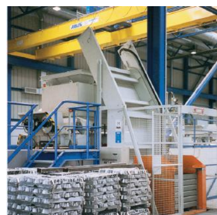
Автоматическая загрузка чушек и возврата
